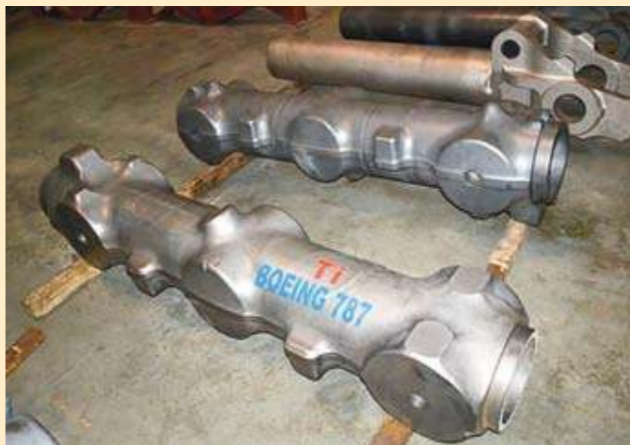
Эти титановые детали от АВИСМА станут опорными для «Дримлайнер»
